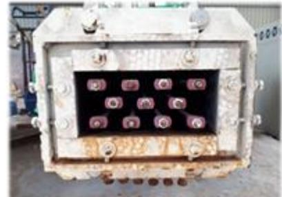
Figure 4 Extrusion die
